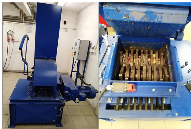
Rysunek 3: Młynek walcowy używany do homogenizacji próbki
